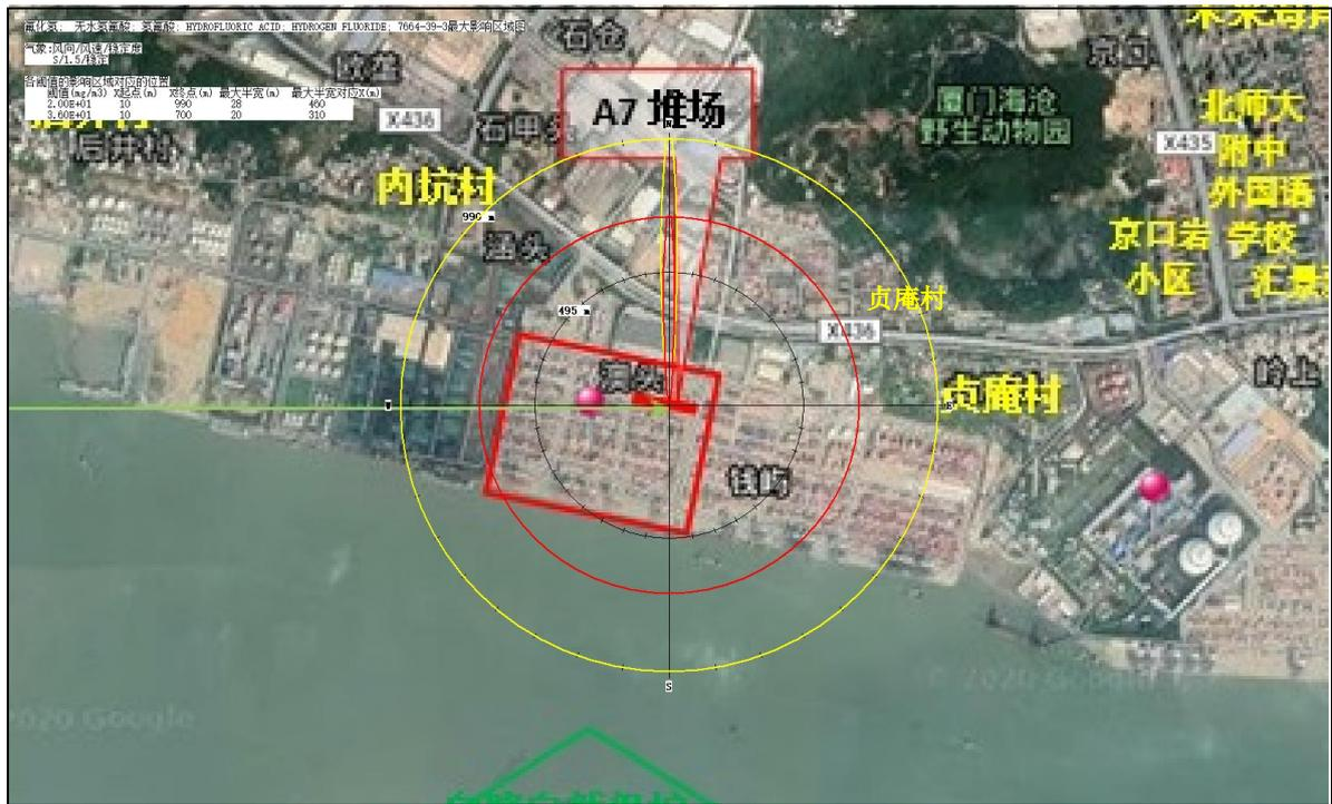
图 6.3-29 最不利气象条件下 70%氢氟酸罐箱全部泄漏时影响范围图
