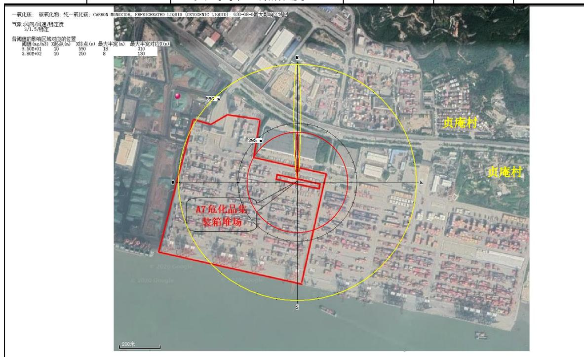
图 6.3-23 最不利气象条件下苯罐箱全部泄漏引发火灾时 CO 影响范围图
