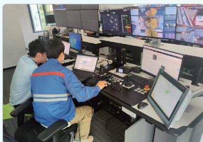
龙门吊统一远控台的操作系统研发项目。通过制定龙门吊远程操作指令、运行状态、视频显示的统一标准和传输协议要求，统一远程操作台数据架构，打破不同厂商远控系统之间的技术壁垒，彻底解决龙门吊因分批改造厂商不同，远控龙门吊无法统一调度的难题，项目已完成系统功能开发，进入现场测试阶段。
